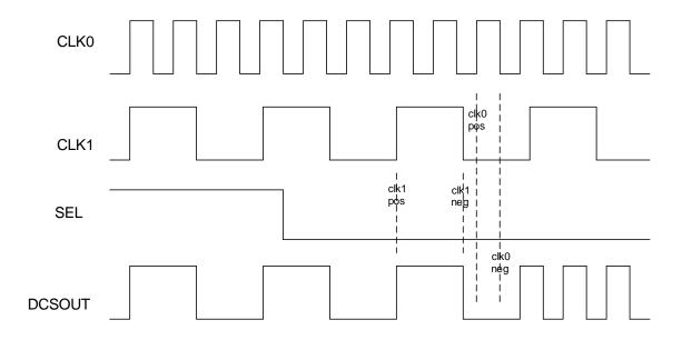
Figure 2.10. DCS Waveforms
