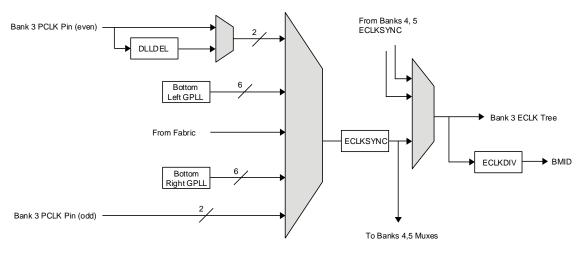
Figure 2.8. Edge Clock Sources per Bank
