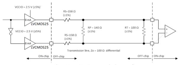
Figure 3.2. LVDS25E Output Termination Example
