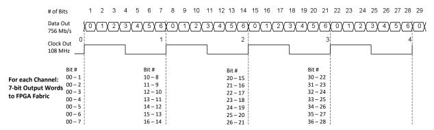
Figure 3.11. DDRX71 Video Timing Waveforms
